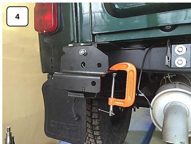
Закрепите на вернюю гайку. Отцентрируйте по отверстиям и закрепите кронштейн на раме автомобиля
