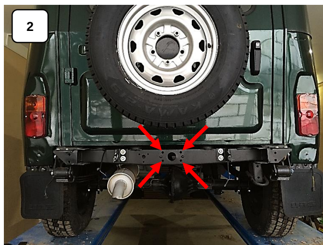
Снимите задний бампер. Установите в штатные отверстия КР7, на КР7 установите КР6, на КР6 Установите КР5 замок. Болты крепления КР5 замка не затягивать.
