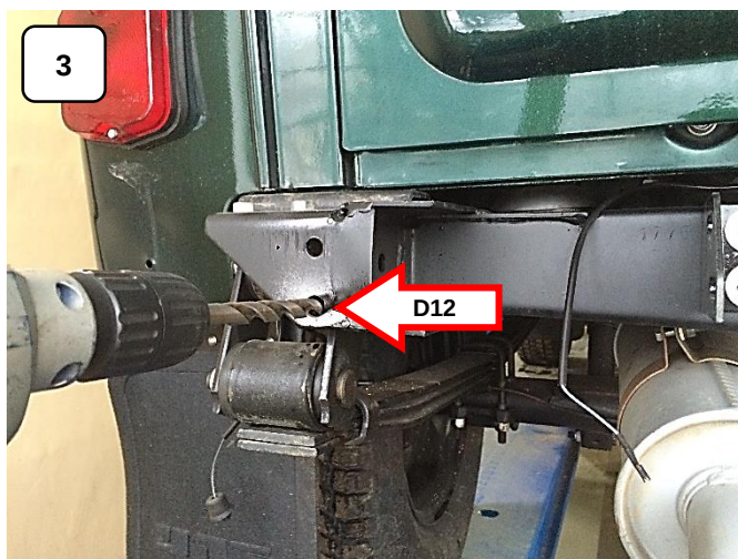
На левом кронштейне рамы расширьте нижнее отверстие до 12 мм
