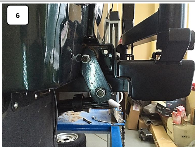
Установите в сборе КР1 и КР2 и закрепите в существующих болтовых соединениях. Важно – шляпки болтов должны устанавливаться изнутри.
